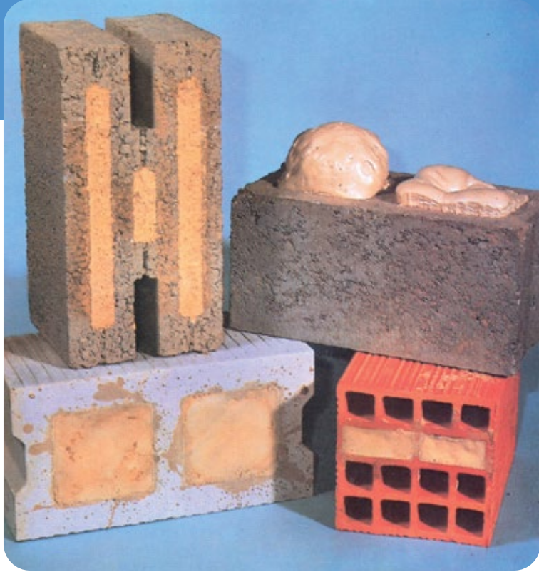
أنواع طوب مختلفة محقونة بمادة البولي يوريثين DIFFERENT TYPES OF BLOCKS FILLED WITH POLYURETHANE FOAM
